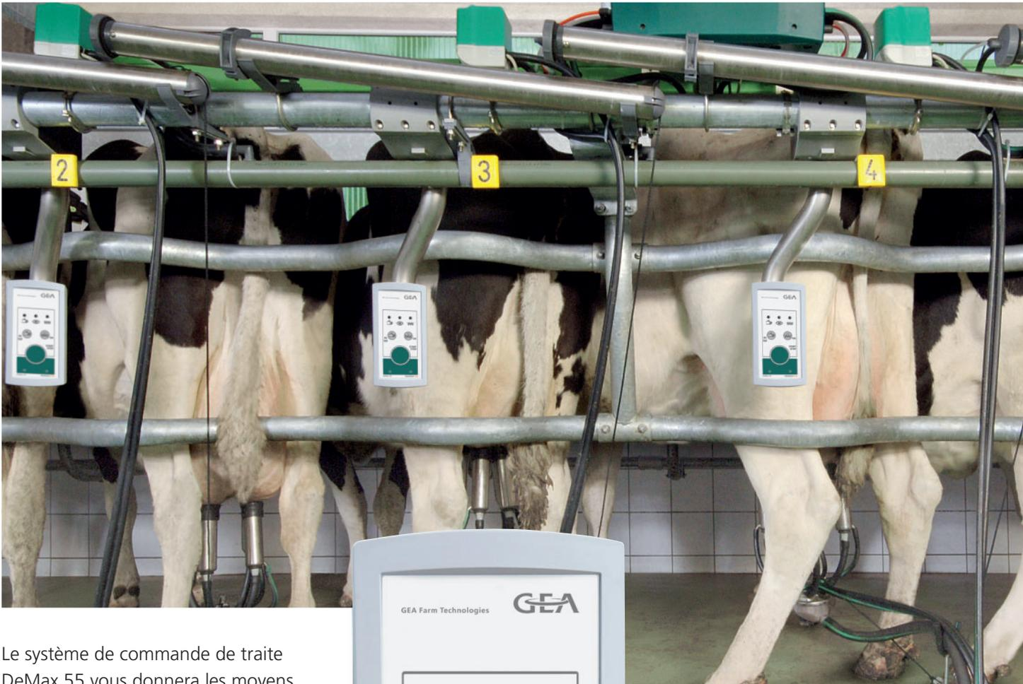
Le système de commande de traite DeMax 55 vous donnera les moyens d'accéder à l'automatisation de la traite et vous propose la solution idéale pour la dépose. La commande individuelle des pulsateurs est une autre fonction de base commune à toutes les commandes GEA Farm Technologies. **StimoPuls** démarre la traite dans les meilleures conditions pour l'animal : équipement parfait, efficace et respectueux des vaches laitières.
